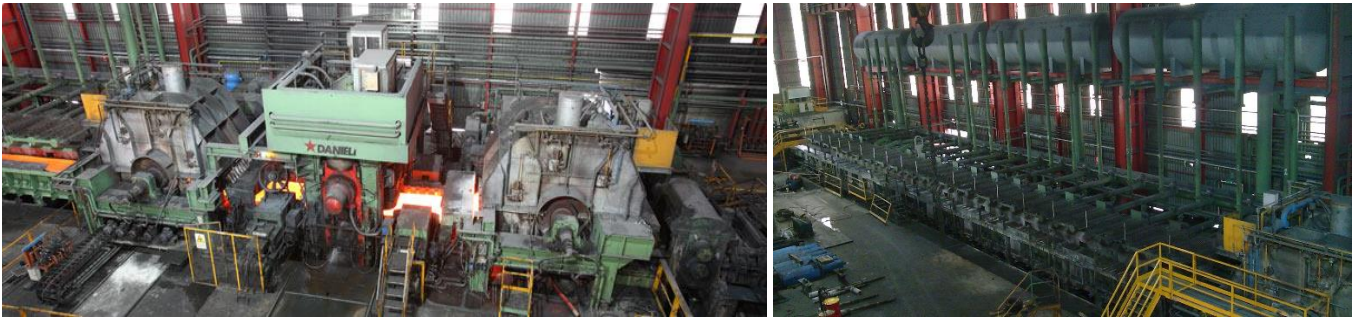
Рисунок 1.18. – Зовнішній вигляд ділянки стану Стеккеля (ліворуч) та установки прискореного охолодження (праворуч)
