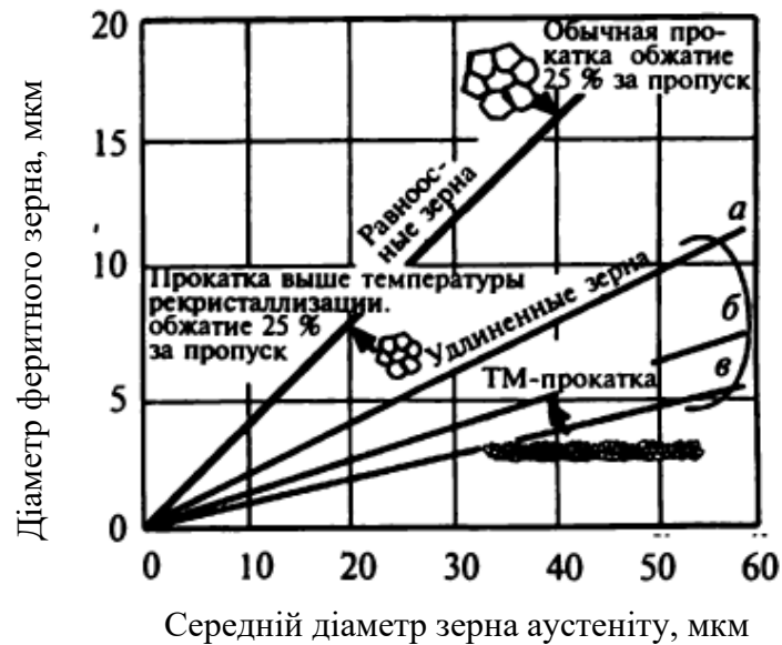
Рисунок 1.21 – Співвідношення між діаметром феритного та аустенітного зерен в залежності від технології прокатки: а – двократна товщина; б – трикратна товщина; в – чотирикратна товщина чистового підкату при деформації нижче температури рекристалізації аустеніту [200]
