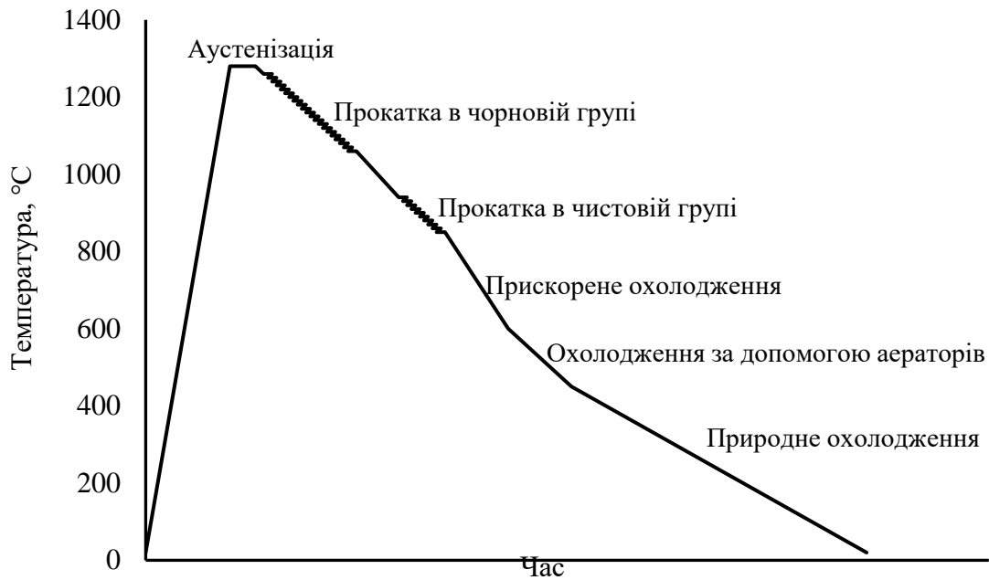
Рисунок 6.22 – Схема термомеханічного процесу прокатки рулонів зі сталі категорії міцності X52 на стані 1700
