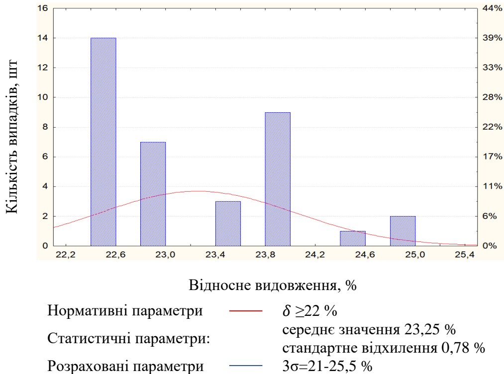
Рисунок 7.15 – Розподіл відносного видовження прокату товщиною 14 мм зі сталі марки К60, зелений рівень процесу
