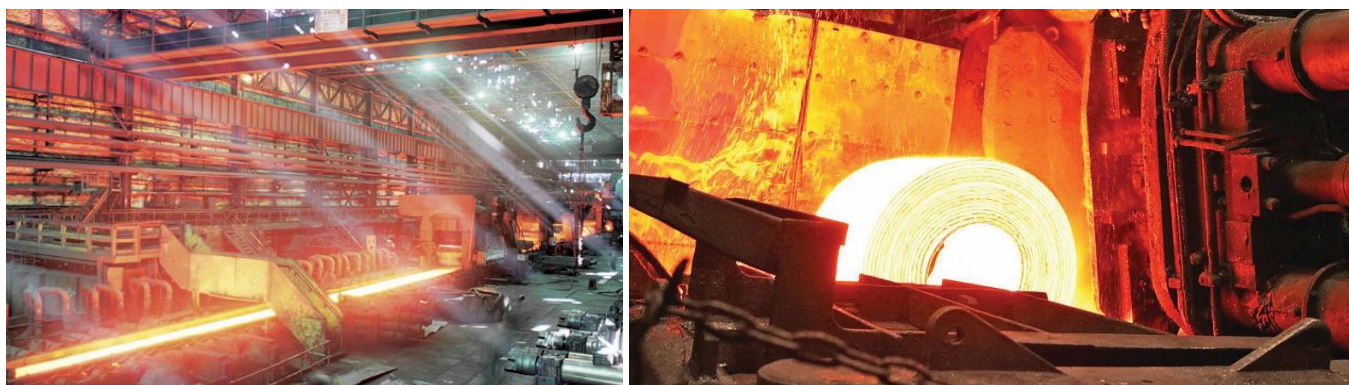
Рисунок 1.16 – Зовнішній вигляд деяких клітей чорнової групи (ліворуч) та установки CoilBox (праворуч) стану 1680
