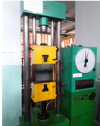
Рисунок 2.1 – Зовнішній вигляд гідравлічної універсальної випробувальної машини моделі Р-20
