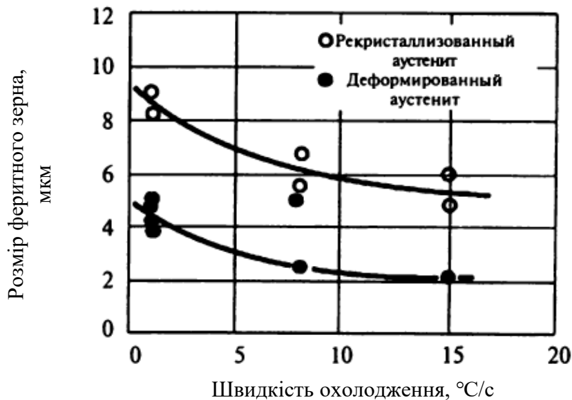
Рисунок 1.23 – Вплив швидкості охолодження на розмір феритного зерна [200, 202]
