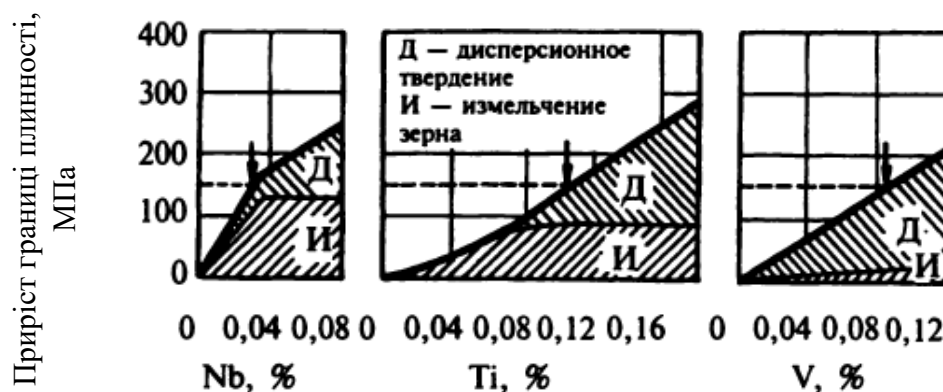
Рисунок 1.22 – Співвідношення ефектів подрібнення зерна та дисперсійного твердіння при мікролегуванні сталі Nb, V та Ti [200]
