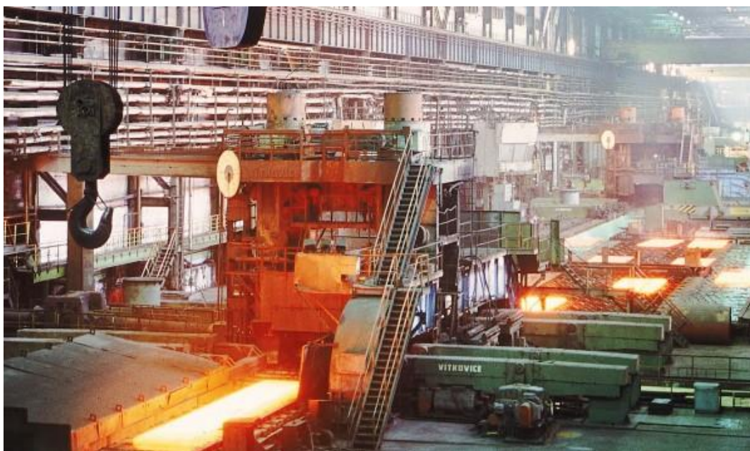
Рисунок 1.8 – Зовнішній вигляд дільниці робочих клітей стану 3000 з зображенням чорнової кліті, байпасу та чистої кліті
